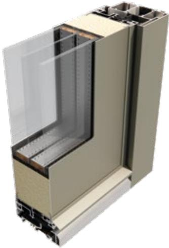
VETROCAMERA con dimensioni variabili in base al modello realizzato con 2 CAMERE e 3 LASTRE DI VETRO. Spessore totale 73 mm. Semicomplanare all'anta di spessore 78 mm.
